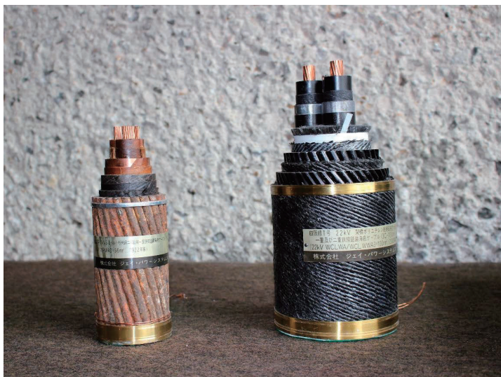
かいてい ひだり ねんせい みぎ ねんせい ▲ 海底ケーブル(左 1922年製 右2008年製)
