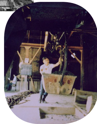
搬器の送り出し の様子 昭和30年代撮影 別子銅山記念館蔵
